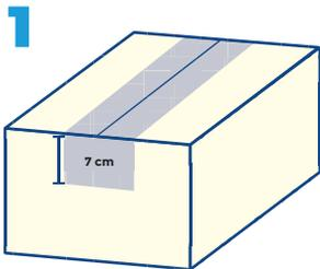
1 Es importante dejar una bandera de 7 cm aproximadamente para garantizar el anclaje de la cinta, la fijación y resistencia en las solapas y el empaque en general.
