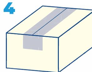
4 Al hacer la aplicación en un solo paso se obtiene uniformidad y se garantiza la resistencia mecánica de la cinta, una vez colocada la cinta puede ejercer presión sobre la misma y así se activará el adhesivo.
