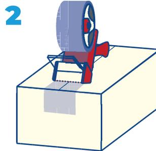
2 Colocar la cinta lo más centrado posible entre la unión de las solapas, con la finalidad de repartir el ancho de la cinta y que la adhesión sea uniforme en ambos lados.
