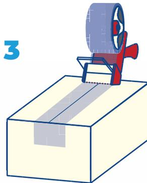
3 Al colocar la cinta sobre la caja (sustrato) se debe ejercer presión con el rodillo del aplicador sin despegar de la caja ni estirarla, procurando que la aplicación sea uniforme, en línea recta y en un solo movimiento.
